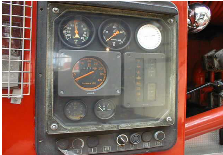
Fig. 7: tablero: manómetro, manovacuómetro, cuenta RPM, nivel de estanque, etc.
