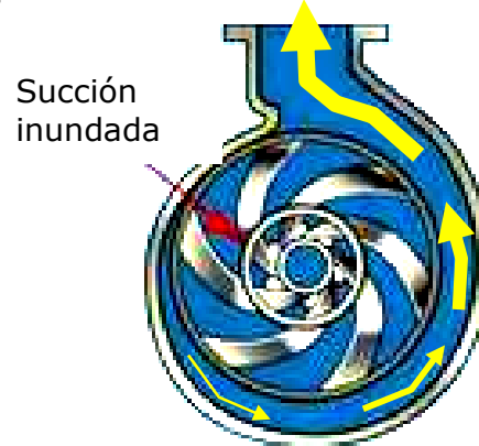
Fig 2 b: rodete e impulsores de la bomba centrífuga succionando y expulsando.
