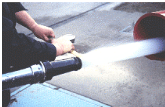
Fig. 19: Prueba de presión de descarga con manómetro pitot.
