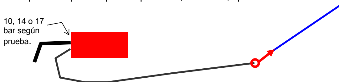
Fig 20: armada para prueba anual de bomba
